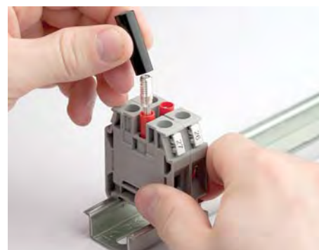
3. Закрепите прижимным винтом проводник в щупе
