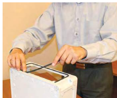
3. Установите уплотнитель на оба объединяемых корпуса
